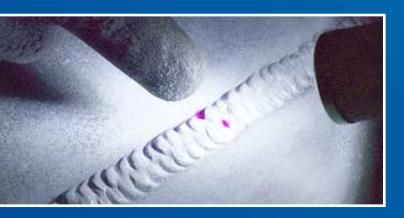
Die Eindringprüfung ist eine zerstörungsfreie Werkstoffprüfung, bei der die Kapillarkräfte von feinen Oberflächenrissen und Poren genutzt werden, um diese sichtbar zu machen. Unterschieden wird hierbei zwischen der Farbeindringprüfung und der fluoreszierenden Eindringprüfung.
