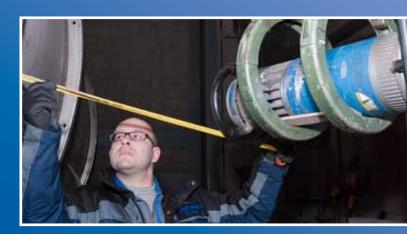
Die Durchstrahlungsprüfung ist ein bildgebendes Verfahren der zerstörungsfreien Werkstoffprüfung (ZFP) zur Darstellung von Materialunterschieden. Mit Hilfe eines geeigneten Strahlers (einer Röntgenröhre oder eines gammastrahlenden Radionuklids, z.B. Selen75 oder Iridium-192) wird die Dichte eines Bauteils auf einem Röntgenfilm abgebildet.
